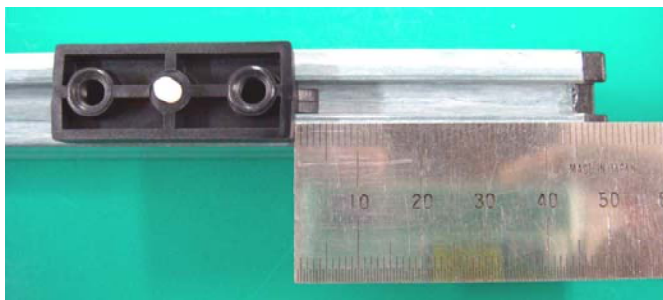
図5 ナローブラケットの取付位置
