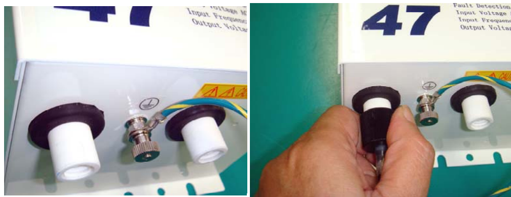
図19 高電圧コネクタの接続
