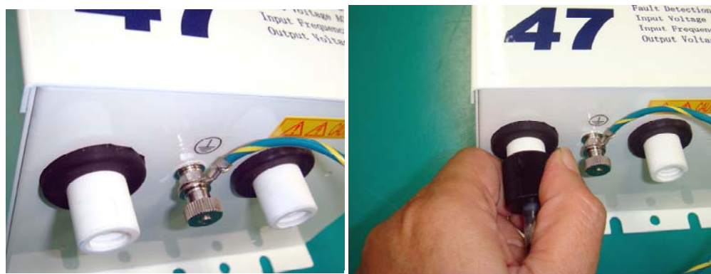
図19 高電圧コネクタの接続
